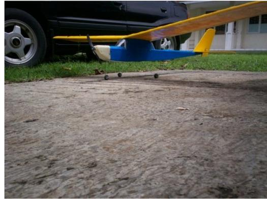
Propeller dan spinner harus kuat pemasangannya. Tidak ada satupun yang kira-kira longgar atau belum di finish atau bahkan belum di check. Antena receiver terjulur keluar tidak boleh tergulung di dalam model.
