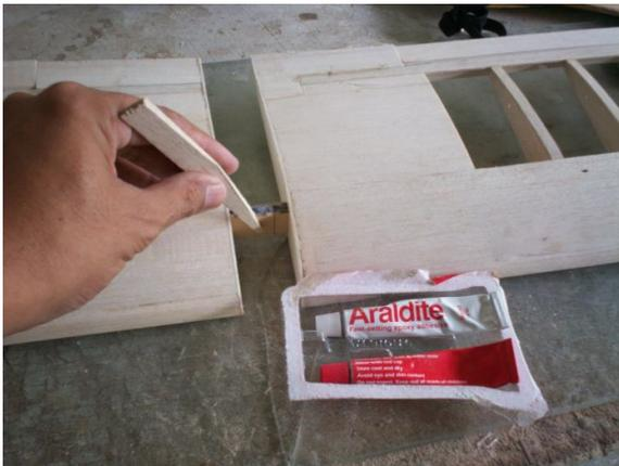
Sayap kanan dan kiri perlu disambung dengan central wing joiner yang dibuat secara khusus dan harus dipasangkan dengan benar, agar sayap kiri dan kanan tersambung dengan kokoh dan tidak mudah patah.
