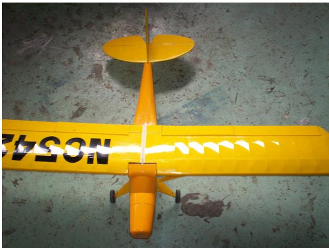
Aileron untuk sayap, gerakan tongkat aileron ke kanan dan amati bahwa aileron kanan harus bergerak ke atas.
