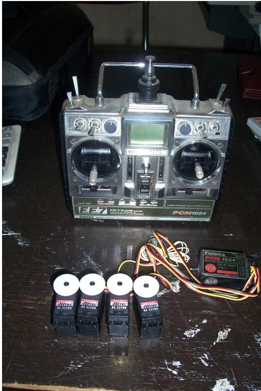
Pesawat model Piper J Cub dirancang untuk menggunakan radio control 4-6 channel.
